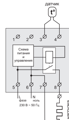
Схема 1. Упрощенная внутренняя схема и схема подключения
